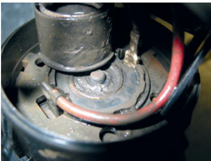
Bir sekonder hava pompasının tahrik motorunda agresif egzoz gazı yoğunluğu
