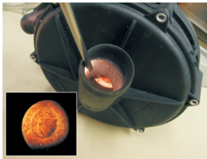
Sekonder hava pompasının korozyonlu girişine yakından bakış
